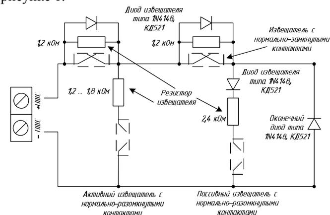
Рис. 1 – Схема включения извещателей в шлейф сигнализации
