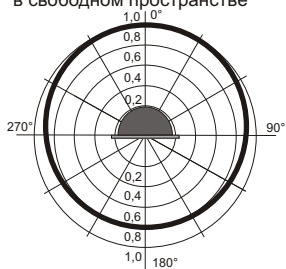
Рис.2 Схема подключения и диаграмма направленности оповещателя.
