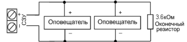
Рис. 2 Схема подключения оповещателей
