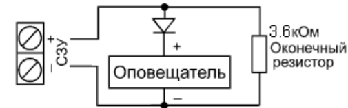
Рис.3 Схема подключения оповещателей с сопротивлением менее 300 Ом
