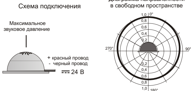
Рис.2 Схема подключения и диаграмма направленности звука оповещателя.
