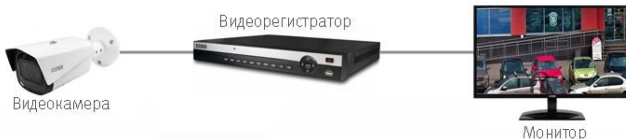
Рисунок 6.2 – Схема подключения видеокамеры
