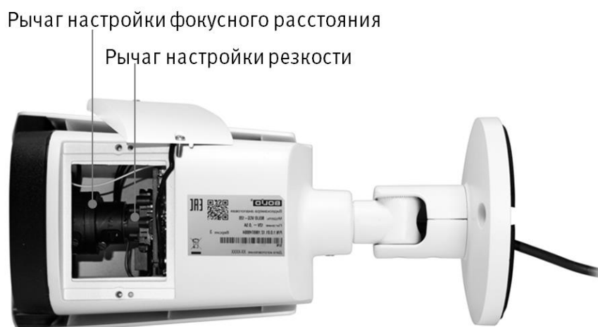
Рисунок 6.4 – Настройка фокусного расстояния и резкости
