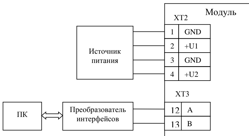
Рисунок 5. Схема для конфигурирования модуля
