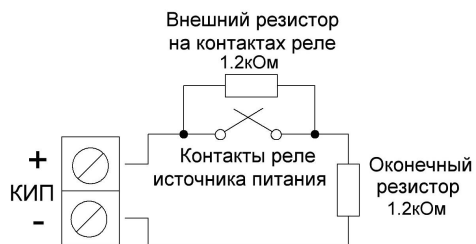
Рисунок 4. Схема подключения шлейфа КИП
