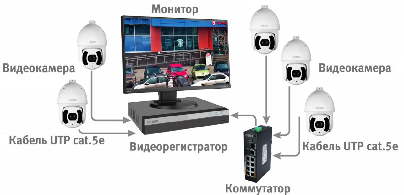
Рисунок 6.4 – Схема подключения видеокамеры к видеорегистратору
