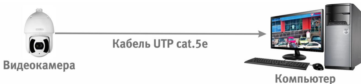
Рисунок 6.2 – Схема подключения видеокамеры к компьютеру
