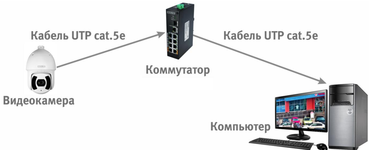
Рисунок 6.3 – Схема подключения видеокамеры к компьютеру через коммутатор
