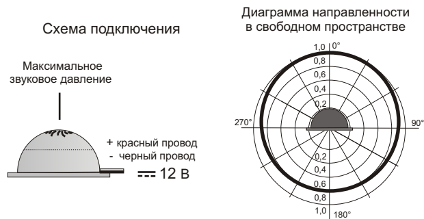
Рис.2 Схема подключения и диаграмма направленности звука оповещателя.
