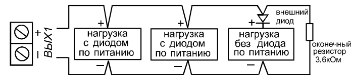
Рис.3 - Схема подключения нагрузки к выходу «ВЫХ1»
