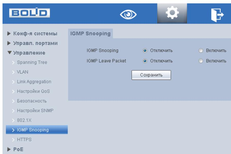
Рисунок 6.35 – Интерфейс IGMP Snooping
