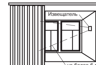
Рисунок 8 – Установка извещателя между стеклом и занавесями (жалюзи)
