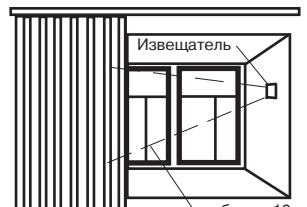
Рисунок 7 – Установка извещателя между стеклом и занавесями (жалюзи)
