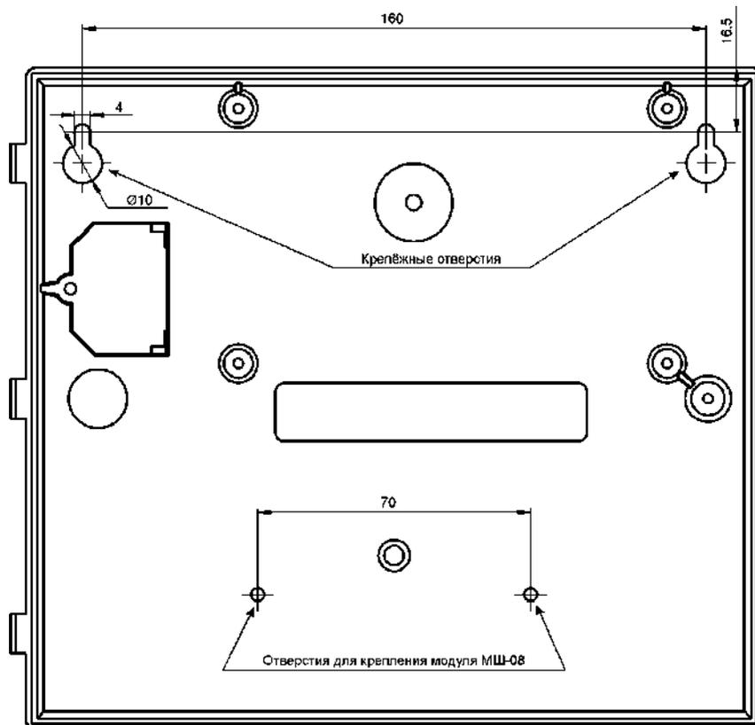
Рисунок 3 - Установочный чертёж корпуса (вид изнутри)
