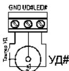
Рисунок В.2 – Подключение УД с тамперными контактами
