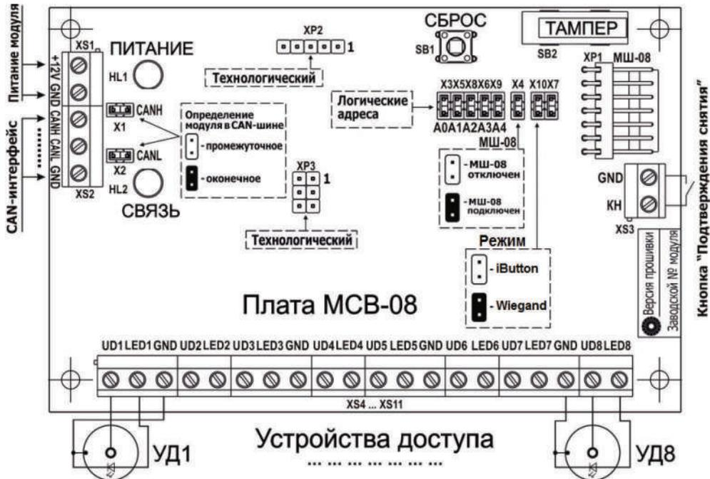
Рисунок В.1 - Внешний вид платы МСВ-08 и схема подключений
