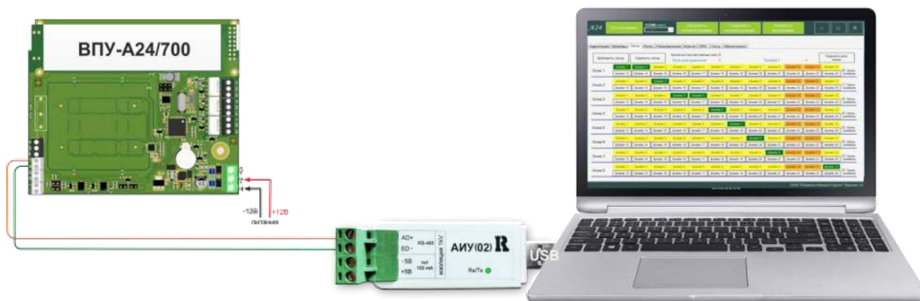
Рисунок 126. Схема подключения для конфигурирования ВПУ-A24/700
