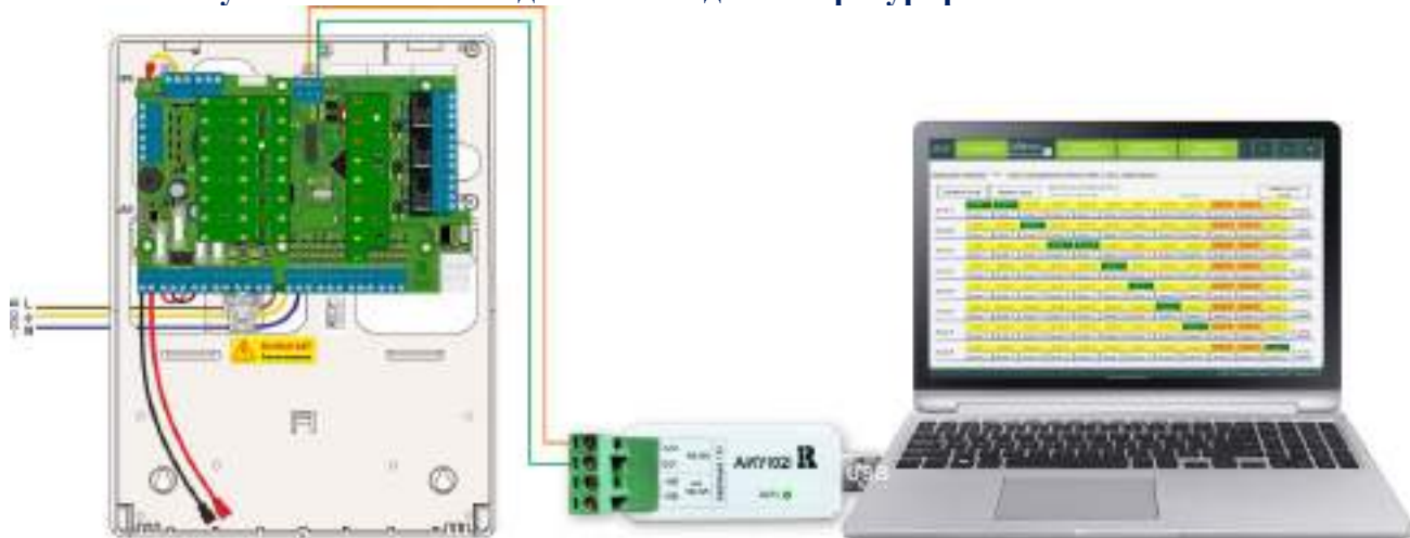
Рисунок 126. Схема подключения для конфигурирования ВПУ-A24/700
