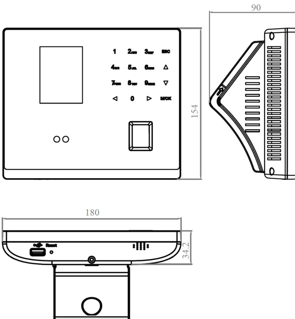
**Рисунок 1.** Внешний вид и габаритные размеры контроллеров
