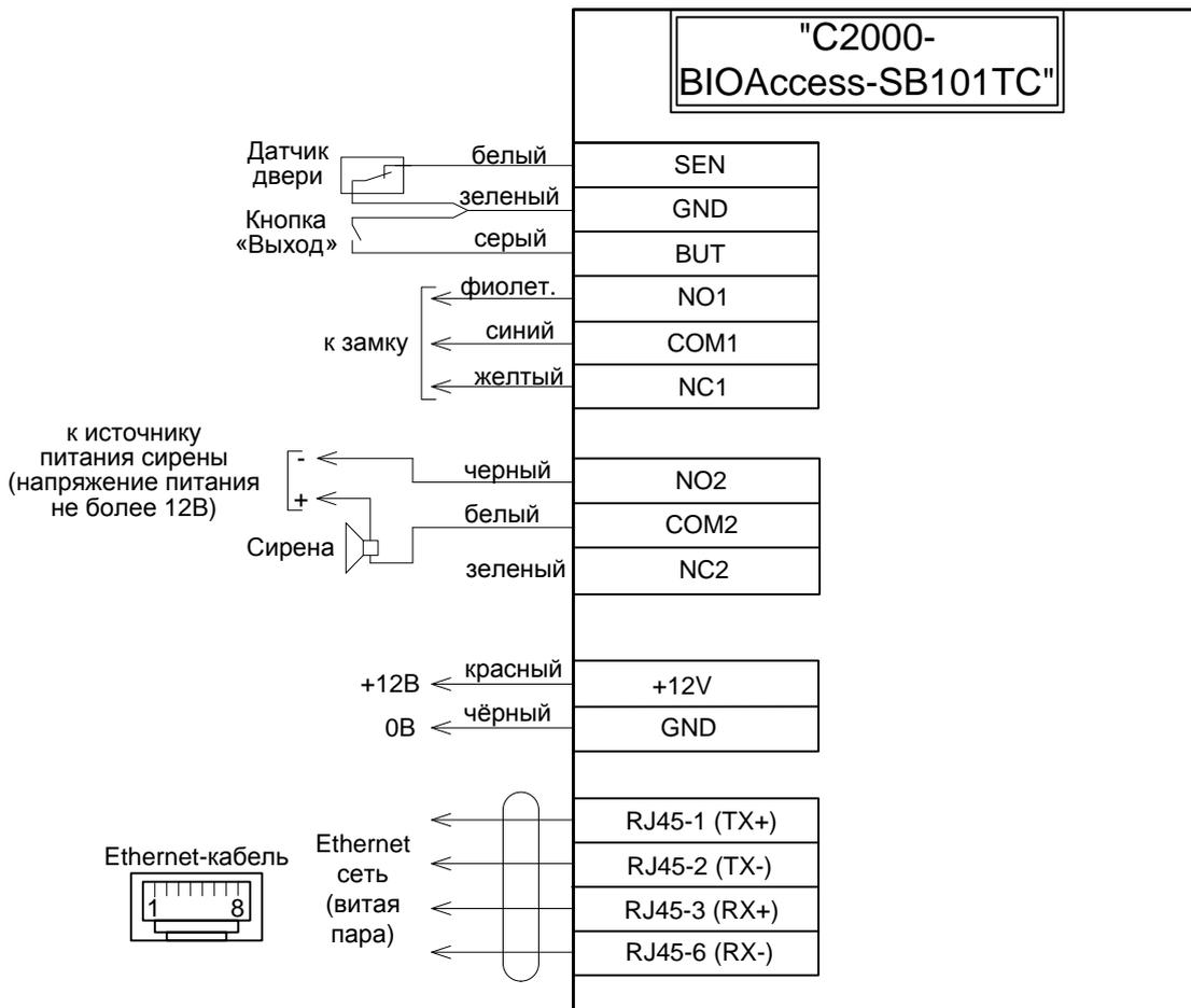
Схемы подключения замков:
