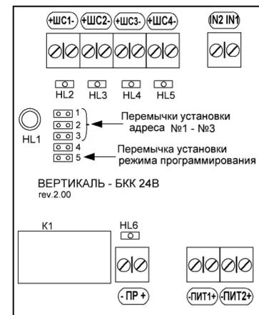
Рисунок 3 - Расположение индикаторов и перемычек на плате БКК
