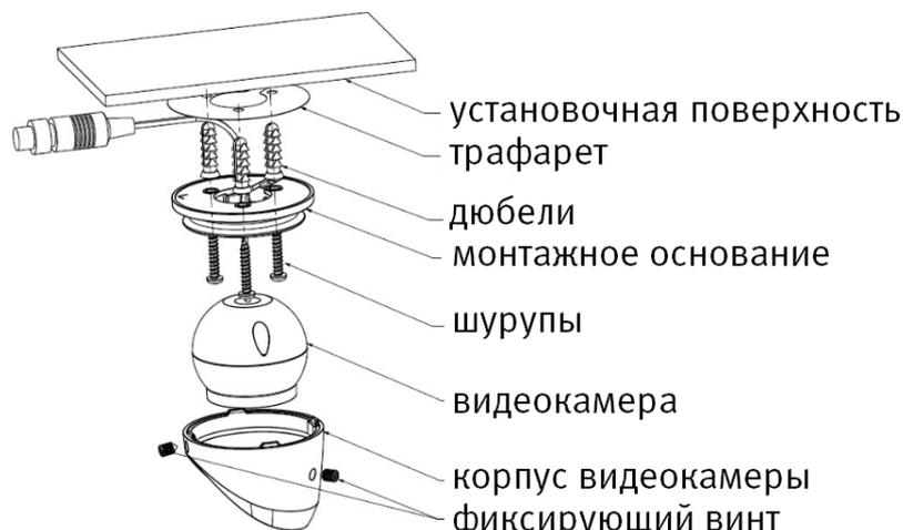
Рисунок 4.2 – Монтаж видеокамеры
