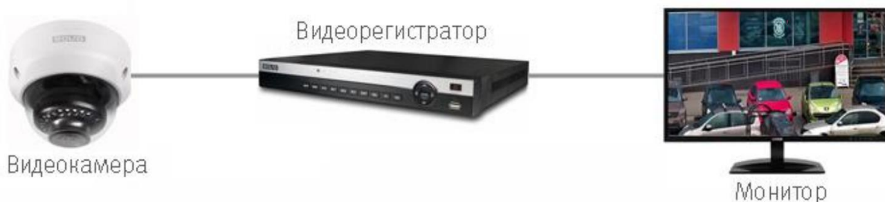
Рисунок 6.2 – Схема подключения видеокамеры
