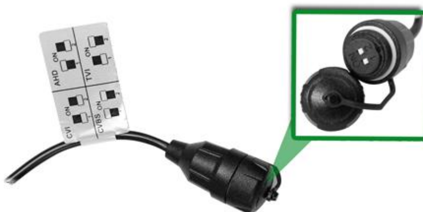
Рисунок 6.3 – Переключатель формата видеосигнала
