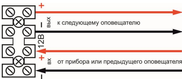
Рис. 2 Внешний вид клеммной колодки и схема подключения оповещателя
