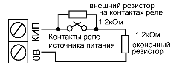
Рисунок 9. Подключение шлейфа контроля источников питания
