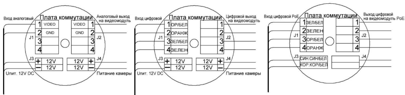
Рисунок 4.3 – Схема подключения термокожуха
