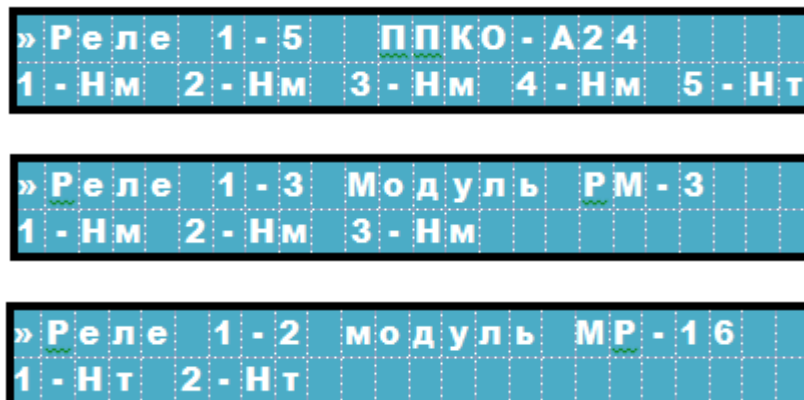
Рис. 32. Вид текущего состояния реле прибора и компонентов
