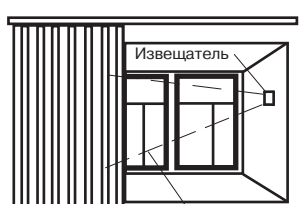
Рисунок 7 – Установка извещателя между стеклом и занавесями (жалюзи)
